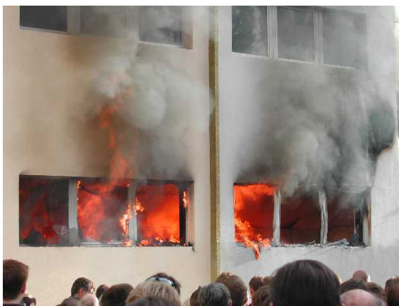
Foto: Fassadenbrandtest (27. Prüfminute)
