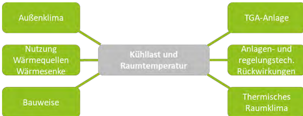
Abbildung 2-3: Einflussparameter auf Kühllast und Raumtemperatur nach VDI 2078
